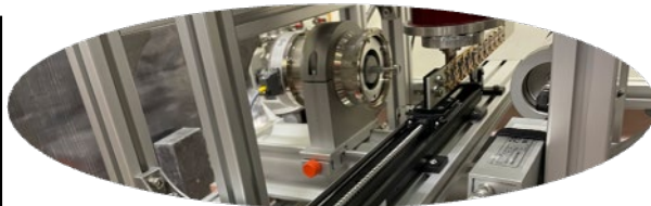
図1 Feガンマ線メスバウア分光装置 (アイソトープ実験施設設置)
