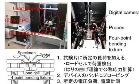
図2. 4点曲げ負荷による電子デバイスの応力-電気特性変動評価試験システム
