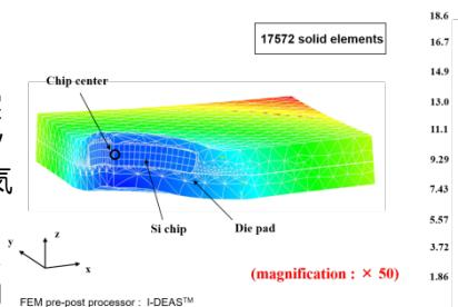
図1. 有限要素法応力シミュレーションによる電子パッケージの残留応力評価
