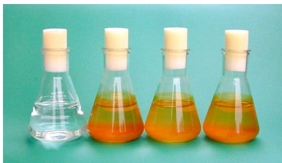
鉄酸化バクテリアを利用したヒ素汚染水の浄化実験 ・バクテリアの投入により、汚染水中のヒ素が沈殿する
